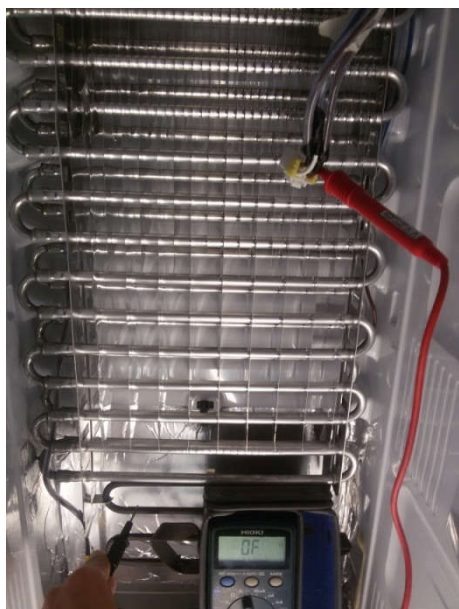
بررسی وضعیت اتصالی سر دوم سیم ترموفیوز به بدنه
