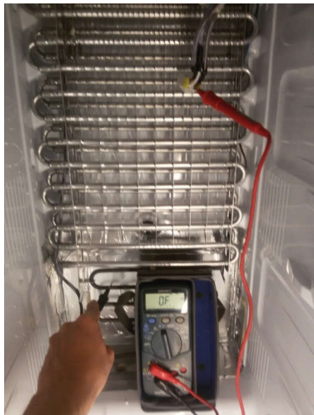
بررسی وضعیت اتصالی سر دوم سیم ترموفیوز به بدنه
